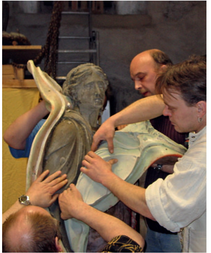
25 Retrait de la membrane en silicone de la reproduction, en la retournant
