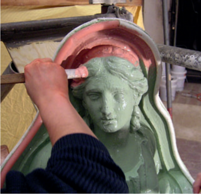
17 Application de la troisième couche de silicone sur la deuxième moitié du moule
